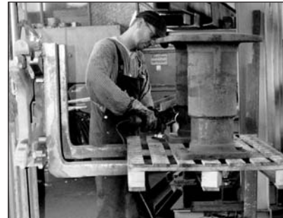
Nachher: Puffer in die richtige Arbeitshöhe gebracht
